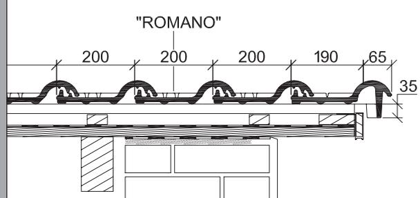
\* Die dargestellte technische Zeichnung ist nur ein Konstruktionsbeispiel. \*\*Laut dem Regelwerk des ZVDH soll bei Ortgangziegeln der Abstand zwischen Innenkante Ortganglappen und Außenkante Giebelwand bzw. Außenkante Bekleidung mindestens 1 cm betragen.
