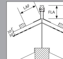
LAF = Lattenabstand zum Firstschnittpunkt (in mm)
